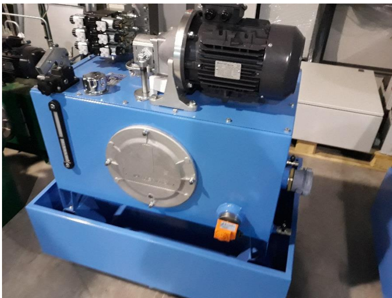
Foto illustrativa della centralina oleodinamica
